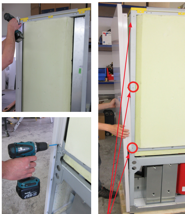
Svitare le viti di fissaggio
