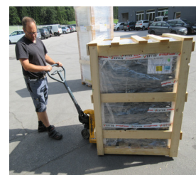
Trasporto di unità interna e esterna con carrello elevatore (transpallet)
