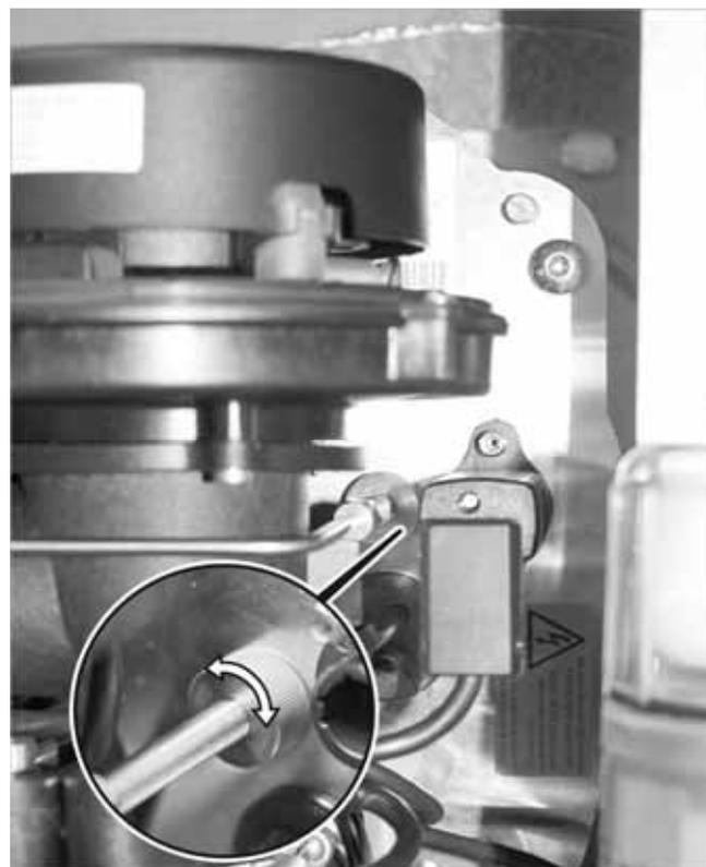
Fig. 137: Dado zigrinato (collegamento tubazione gasolio / supporto ugello)
