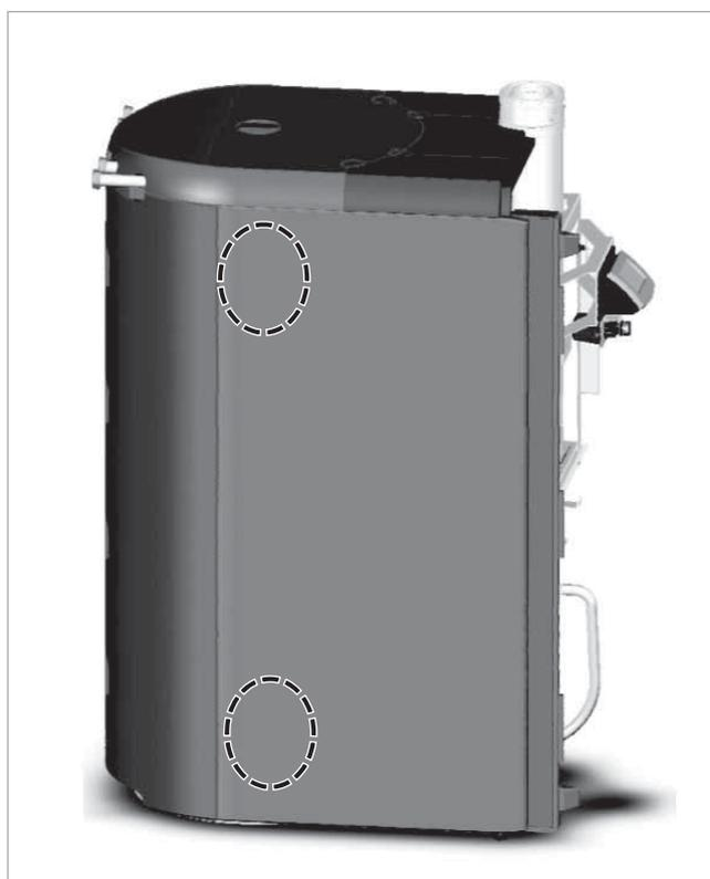
Fig. 120: Pressione della parte laterale
