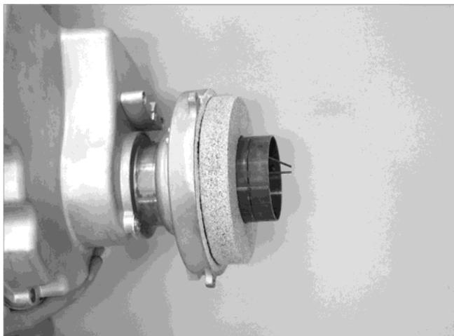
Fig. 62: applicazione del portello caldaia con isolante refrattario
