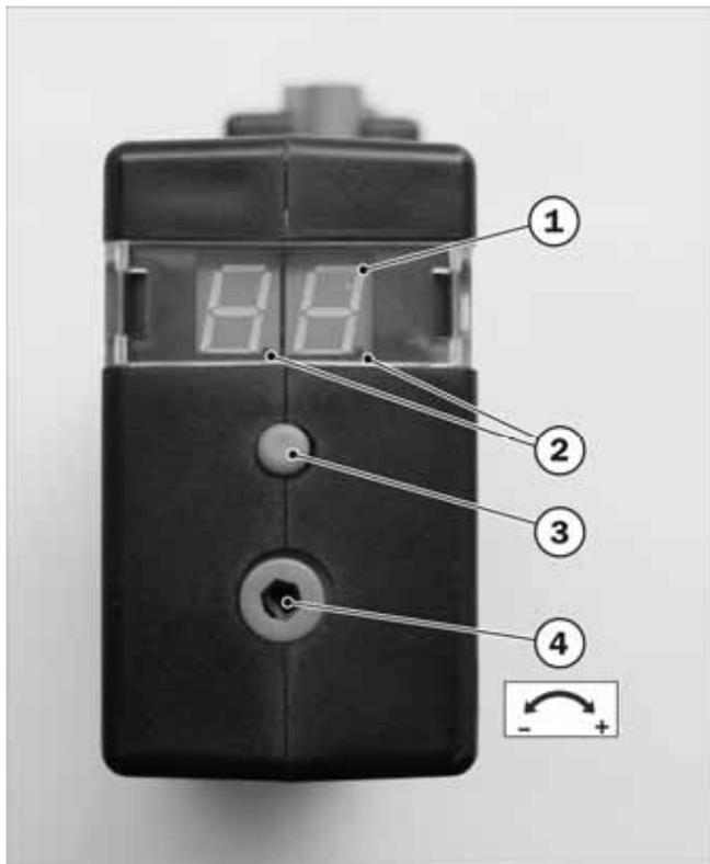
Fig. 105: Impostazione del numero di giri del soffiante dall'interfaccia
