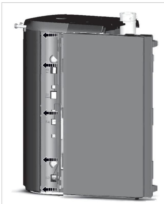
Fig. 119: Inserimento della parte laterale
