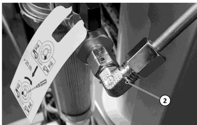
Fig. 76: Fissaggio della tubazione di alimentazione del gasolio al filtro
