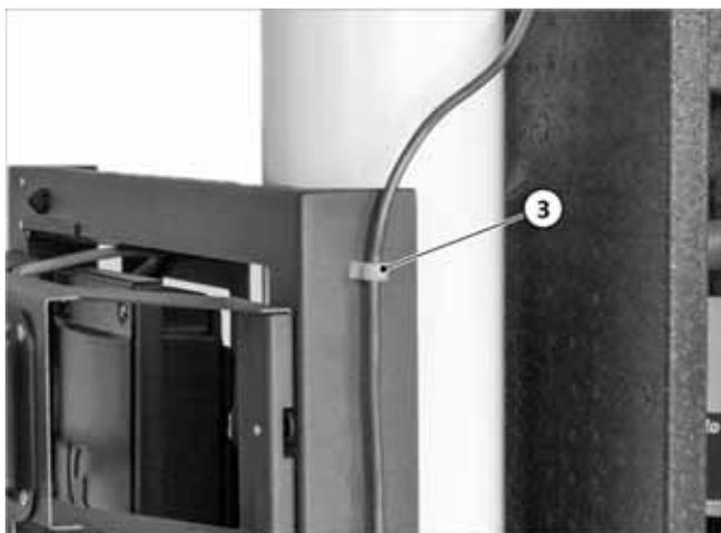
Fig. 77: Fissaggio della tubazione di alimentazione del gasolio al telaio
