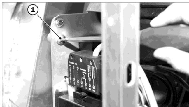
Fig. 130: Viti a serraggio rapido nell'inserto del bruciatore
