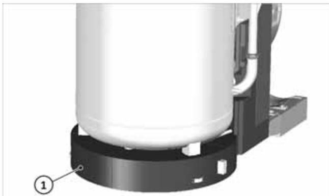
Fig. 13: Posizione della base circolare (1) sotto l'accumulatore
