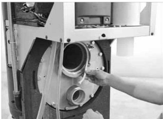
Fig. 58: Inserimento del cordoncino di tenuta del bruciatore
