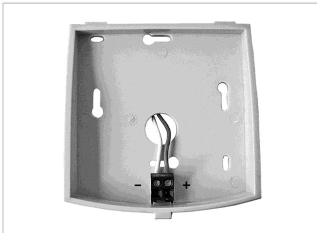
Fig. 99: collegamento dell'elemento di regolazione ambiente
