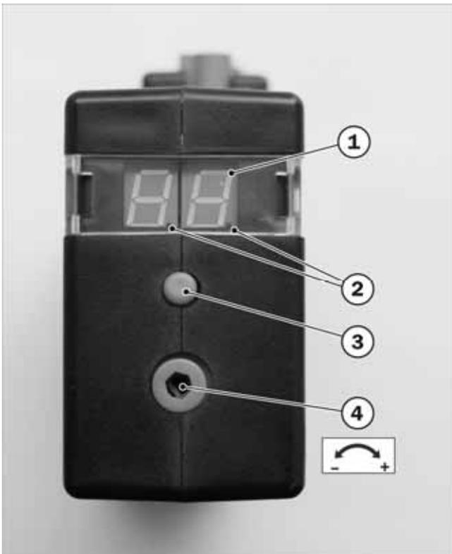
Fig. 138: Interfaccia dispositivo automatico di controllo bruciatore CM 168
