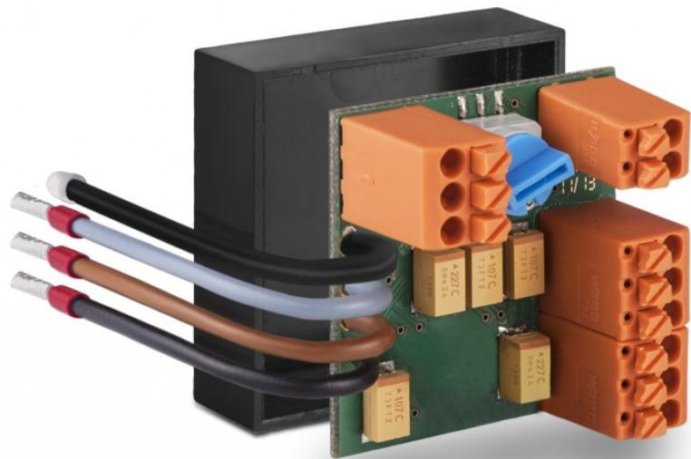
La centralina universale é una centralina multifunzionale da 12 Volt, che viene gestita da un semplice interruttore bipolare. Per ogni tipo di ventilatore si possono scegliere diversi programmi.
