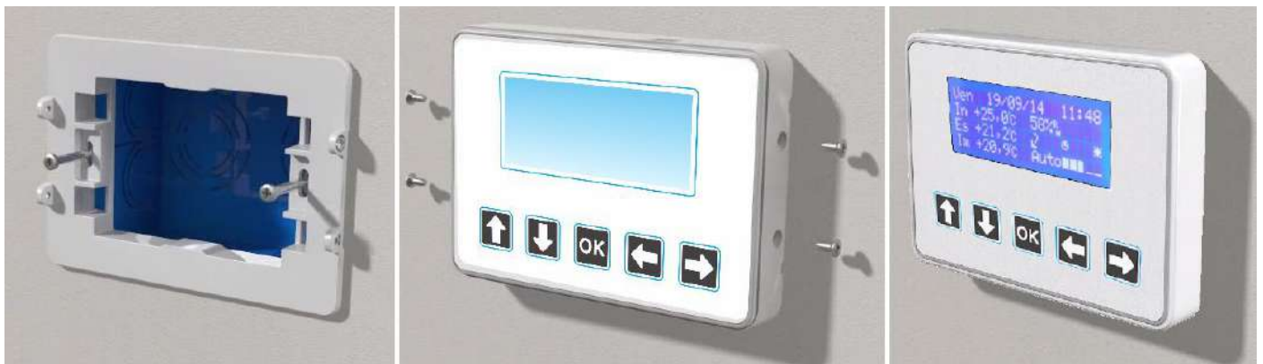
Figura 2 - Sequenza installazione controllo remoto LCD
