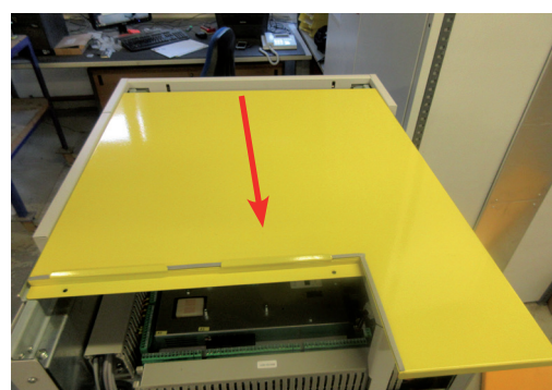
Tirare il pannello di copertura in avanti e toglierlo
