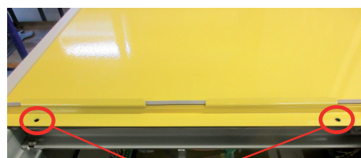
Svitare le viti di fissaggio del coperchio
