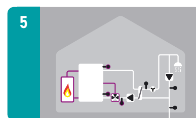
Produzione ACS con ricircolo, funzione aggiuntiva termostato e controllo temperatura ritorno (*)
