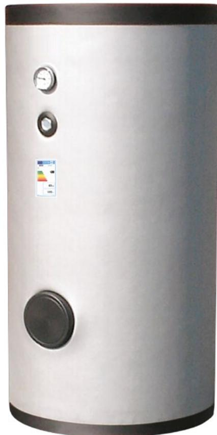
Bollitore in acciaio al carbonio vetroporcellanato per la produzione e lo stoccaggio di acqua calda sanitaria dotato di uno o due scambiatori interni fissi a serpentino ad alta superficie di scambio; possono essere alimentati da pompa di calore e impianto solare.
