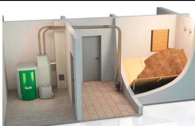
Pellematic con magazzino pellet e sistema di aspirazione sottovuoto
